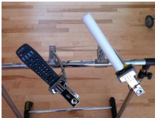
CD プレーヤーのリモコンの再生信号を学習リモコンに記憶させることによって、係活動として、朝の歌の CD を再生することが可能になります。写真では、学習リモコンに棒スイッチをつないでいますが、児童生徒の得意なスイッチに付け替えることができます。
