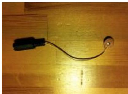
写真のような BD アダプターを既製のおもちゃや電子機器の電池ボックスにつなぐことで、自分の得意なスイッチで動かすことが可能となります。
