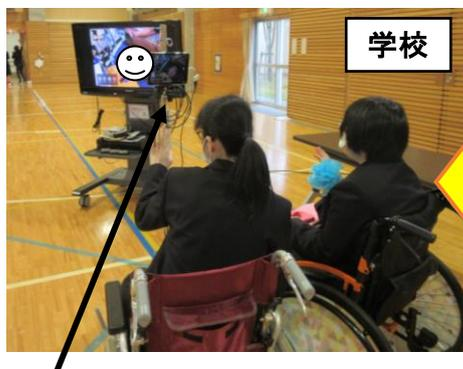
タブレット型情報端末（iPad）をキャスター付きの三脚に固定し、HDMI ケーブルと Lightning ケーブルでモニターに接続しています。活動に合わせて移動しやすく、誰でも気軽に声を掛けやすい状況を作っています。
